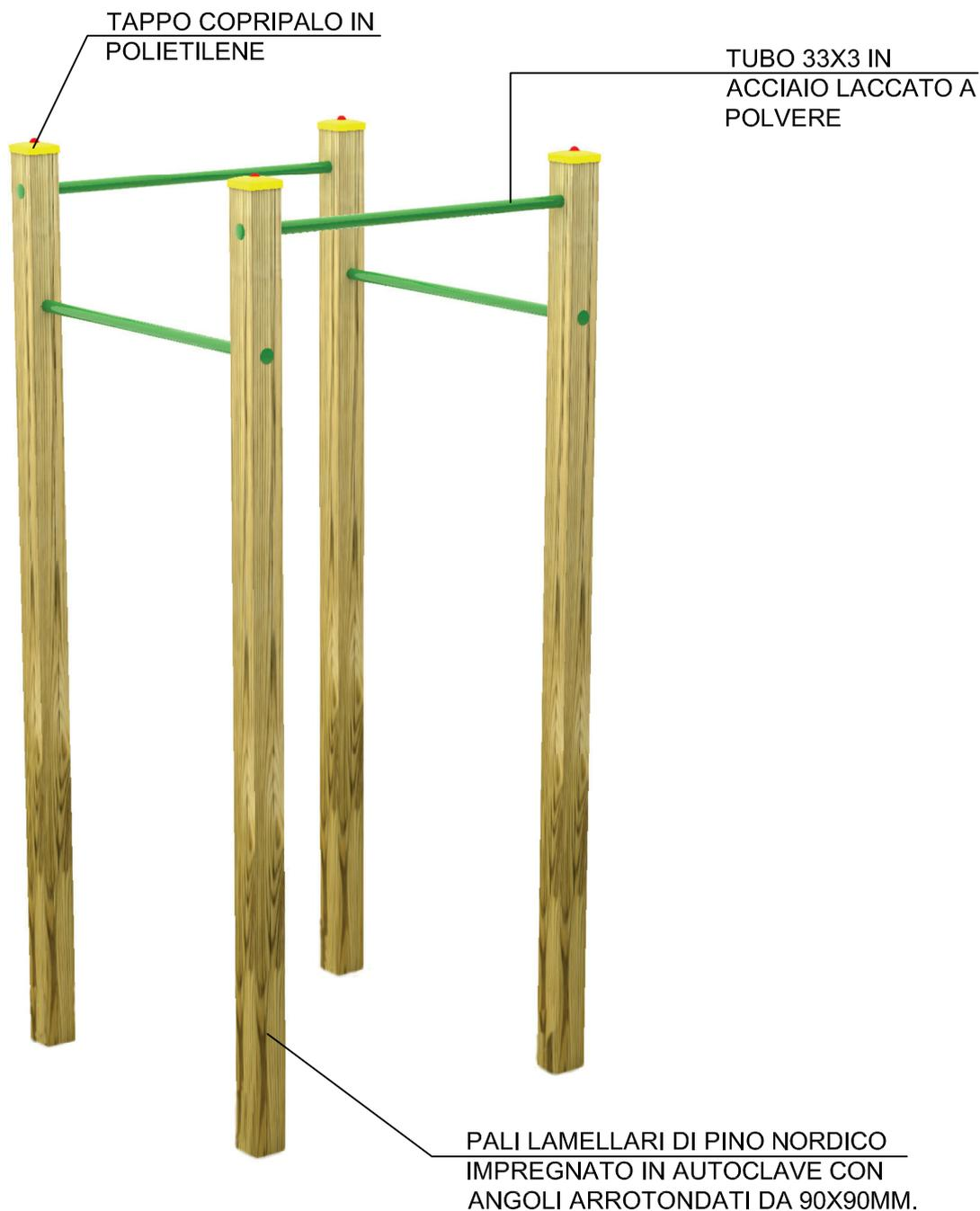
TUTTI GLI ELEMENTI DI FISSAGGIO, VITI, DADI, RONDELLE ECC. SONO IN ACCIAIO ZINCATO E PROTETTI DA GHIERE E TAPPI IN POLIETILENE
